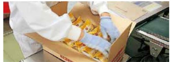
重量チェックや金属探知機、X線探知機を経て、最終的に目視でチェックします。その後、印字の状態を確認しながら丁寧に箱詰めします。
