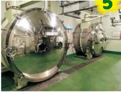
気圧を下げて、真空状態にします。気圧を下げることで、水の沸点が下がり、氷点下で水分が氷の状態から水蒸気になります。商品がダメージを受けることが少なく、おいしく食べるための重要な工程です。
